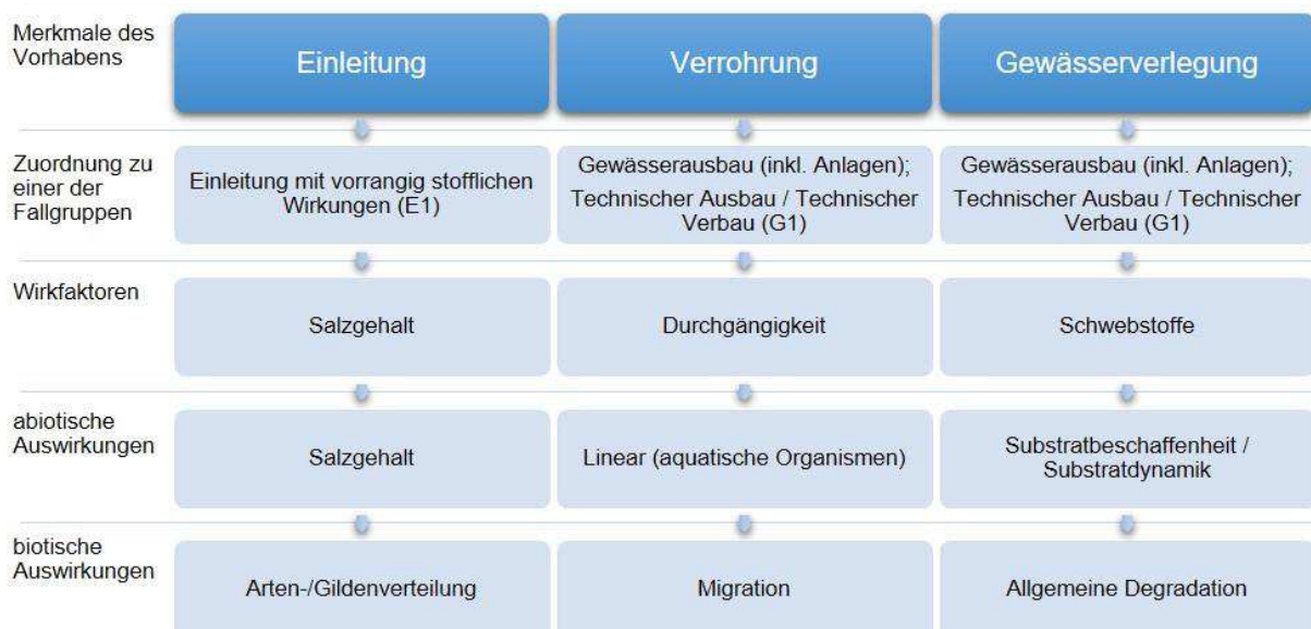
Abbildung 6 Wirkpfade anhand von drei Beispiel-Merkmalen eines Vorhabens mit jeweils einem Beispiel für die potenziellen Wirkfaktoren und die potenziellen Auswirkungen für Fließgewässer
